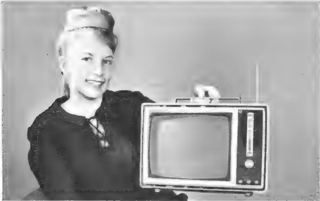
Das neue tragbare Zweitgerät Chico von Kuba-Imperial ist als Vollbild-Fernsehempfänger ausgeführt; bei dem abgebildeten Exemplar der Null-Serie ist das genaue Verhältnis allerdings noch 3,07 : 4
